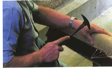
Les flèches indiquent les semences d'appoints avant le rabattage. Position du pouce et de la main lorsque l'on enfonce la semence au rabattage.
